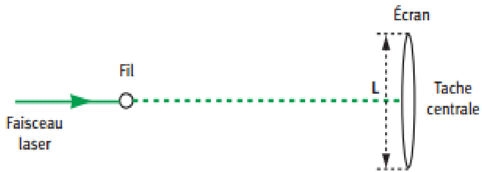
Figure 2 : vue de dessus : le fil est perpendiculaire au plan de la figure
